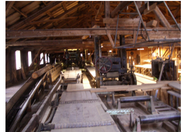
Spillumsågen är en välbevarad såg som delvis är i bruk med en ursprunglig såghall med ramsåg och hyvleri
